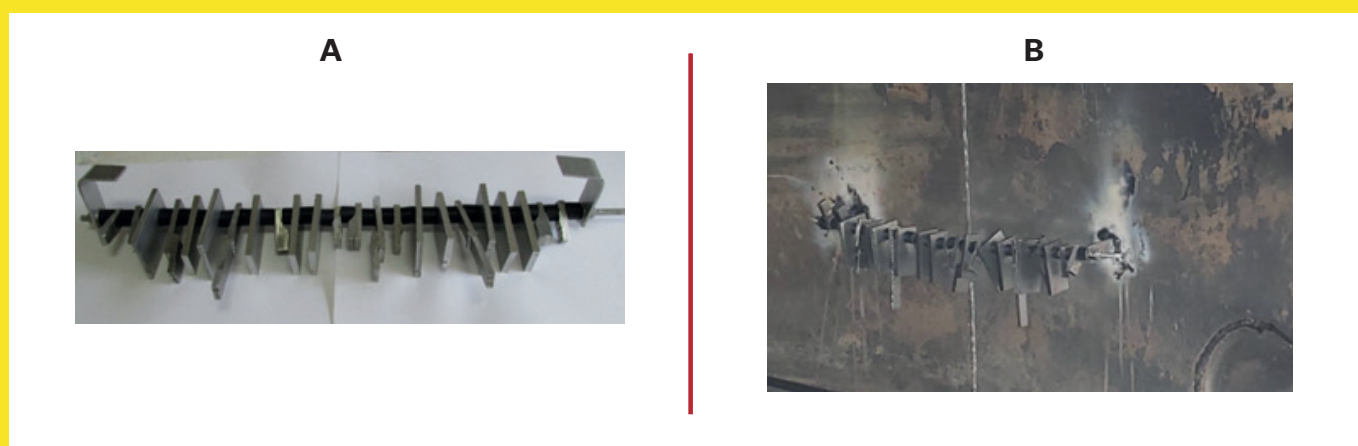
FIGURA 1: A - DETALHES DO ARRANJO DOS CPS E B - COMO FORAM EXPOSTOS NO FUNDO DA COLUNA DE DESTILAÇÃO DA USINA SÃO JOSÉ DA ESTIVA
